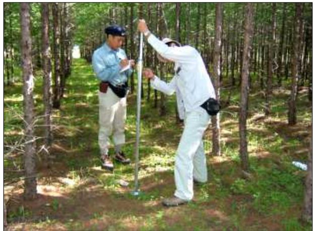
■ 土壌貫入計による土壌硬度の計測
